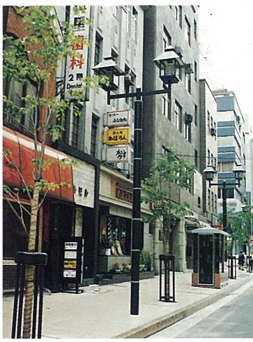
【解説】老舗の並ぶ銀座西並木通りの環境整備。設計にあたり、地元商店街より、シックで深みのあるデザインを求められた。年月を経るほどに表情を豊かにするであろう自然石を舗装材に選び、ブラジル産の茶御影を採用した。陰気な植込みを取り除くとともに、中央区、築地警察、警視庁と協議して幅員を25cm拡げ、開放的で明るい歩道とした。リンデンの並木に香りの出る電話ボックスを置き、モダンなデザインの街路灯は町の長老に否定されガス灯のイメージの街路灯とした。【高橋志保彦】
