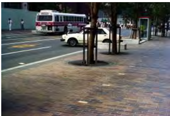
＜図6＞福岡都心軸モール。駐車場の出入り口も簡単な車止め石を入っただけで、出来るだけ歩車道を区分せずオープンな空間にしている。
