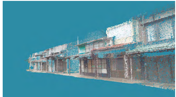
FARO(専門機材)による精度の高いスキャン結果
