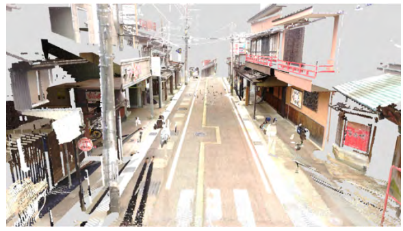
FARO(専門機材)による精度の高いスキャン結果
